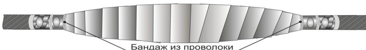
19. Расплести концы провода заземления, разложить провод вдоль муфты. Закрепить провод бандажами из стальной оцинкованной проволоки на оболочке и броне кабелей и припаять припоем ПОС к заранее облуженным местам на оболочке и броне кабелей. При пайке применять паяльный жир. Пламя горелки должно быть направлено по касательной к бронелентам.
