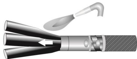
5. Надеть на жилы кабелей термоусаживаемые маслостойкие трубки № 3 для изоляции жил (на жилы кабеля с большей длиной разделки – трубки длиной 450мм; на жилы кабеля с меньшей длиной разделки – трубки длиной 350мм) так, чтобы торец трубки доходил до ступени поясной изоляции кабеля, и усадить, начиная от корешка разделки, равномерным прогревом пламени газовой горелки. Пламя горелки
