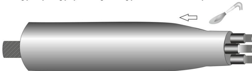
**3.14.** Не подвергать муфту механическим нагрузкам до полного остывания.
