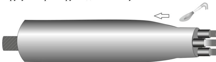
**3.15.**Не подвергать муфту механическим нагрузкам до полного остывания. Монтаж муфты закончен.
