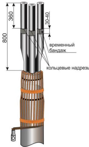
**5.** Обрезать жилы кабеля на длине 800мм от выступа внутренней оболочки. Развести жилы кабеля. На каждую жилу на расстоянии 360мм от торцов наложить временный бандаж шириной 30-40мм из полосок наждачной бумаги и зафиксировать лентой ПВХ. Бандаж должен быть выполнен строго перпендикулярно оси токопроводящей жилы. Производим кольцевой поперечный надрез полупроводящего слоя до изоляции жил, используя временный бандаж, как упор.
