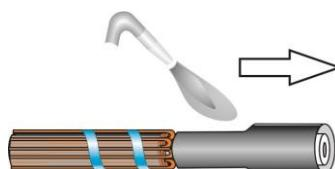
**2.8.**Надвинуть на каждую жилу трубки для изолирования жил пластмассового кабеля и усадить, начиная от сгиба экрана. Остатки воздуха не допустимы.
