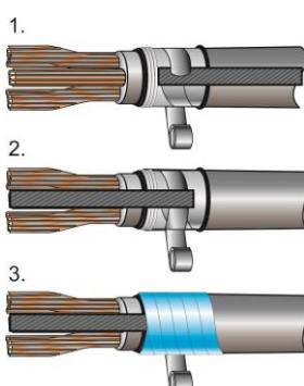
**3.10.**Со стороны кабеля с изоляцией из спитого полиэтилена установить провод заземления так, как показано на рисунке. После этого сделать один
