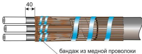
**2.6.**С помощью специального инструмента (роликового ножа) снять электропроводящий экран с жил кабеля, оставив участок электропроводящего экрана длиной 40мм от места загиба проволочных экранов кабеля. На жилах не должно оставаться неснятых элементов электропроводящего слоя, царапин и т.п. Поверхность
