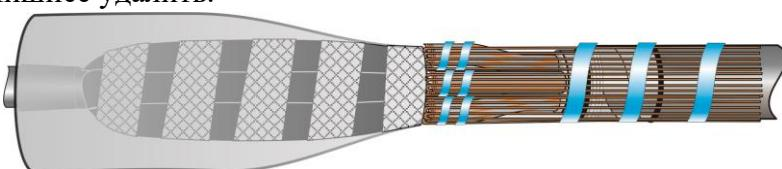
**3.8.**Обмотать поверхность трубы лентой алюминиевой так, чтобы края ленты заходили на металлическую оболочку кабеля с бумажной изоляцией на 10 мм, и закрепить ленту алюминиевую на оболочке кабеля с бумажной изоляцией бандажом из 4-5 витков проволоки. Удалить края ленты, выступающие за бандаж.
