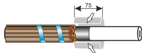
**2.9.**С конца каждой жилы обоих кабелей снять фазную изоляцию на длине, равной половине длины соединительной гильзы.
