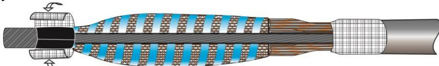
**3.13.** Разложить пластины (300мм) заполнителя вдоль межфазных пустот на кабеле с СПЭ изоляцией от загиба проволок экрана до выступа заполнителя кабеля. Вдавить пластины небольшим усилием.
