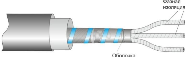
**1.6.**Надеть на жилы кабелей термоусаживаемые трубы №3 для изоляции жил так, чтобы торец трубы доходил до ступени поясной изоляции кабеля, и усадить, начиная от корешка разделки, равномерным прогревом пламени газовой горелки. Пламя горелки должно быть размытым, желтоватого цвета. После усадки трубы должны плотно облегать жилы кабеля, не иметь морщин и складок.
