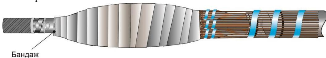
**3.9.**Освободить проволочные экраны трехжильного кабеля с изоляцией из СПЭ от бандажей. Проволоки выпрямить и разложить вдоль муфты параллельно друг другу с заходом на броню кабеля с бумажной изоляцией по всему периметру. Закрепить лентой ПВХ и проволочными бандажами на оболочке и броне и опаять. Выступающие концы проволок удалить.
