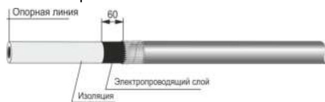
**5.** С конца каждой жилы снять фазную изоляцию на длине, равной половине длины соединительной гильзы.
