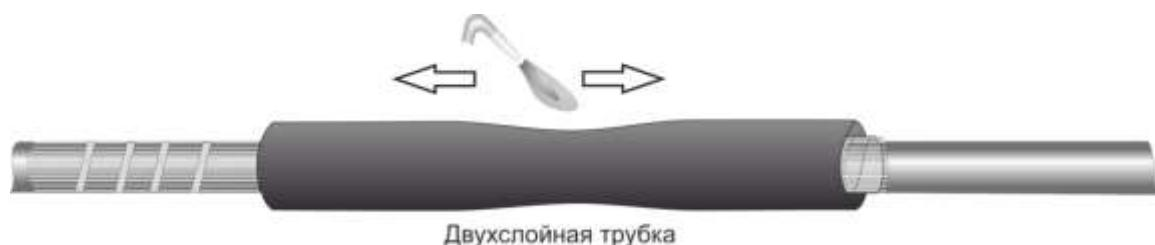
**23.** На усаженную двухслойную трубку произвести намотку с перехлестом 30% экранирующей сетки.
