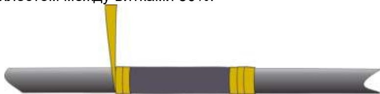
**13.** Тонким слоем по всей окружности экранирующей трубы и жильной трубы стресс-контроль, не заходя на жёлтую ленту, нанести пасту КПД.
