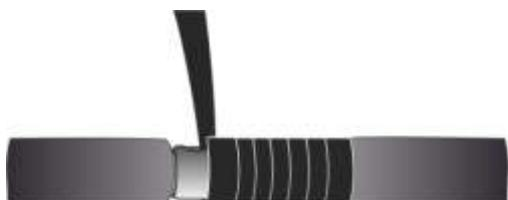
**11.** На гильзу кабеля надвинуть экранирующую трубку, расположив её симметрично относительно центра соединительной гильзы. Усадить пламенем горелки в соответствии с рисунком.
