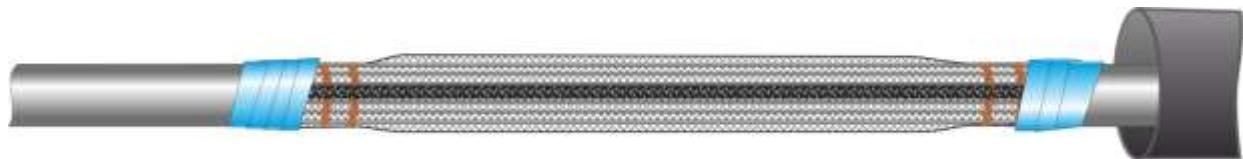
**27.** По краям кабельной муфты наложить ленту-герметик, входящую в комплект.
