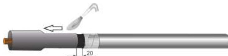
**8. Внимание! Для предотвращения загрязнения внутренней поверхности защитных кожухов необходимо на оболочку соединяемых кабелей предварительно надеть и зафиксировать плёнку рукавную.**
