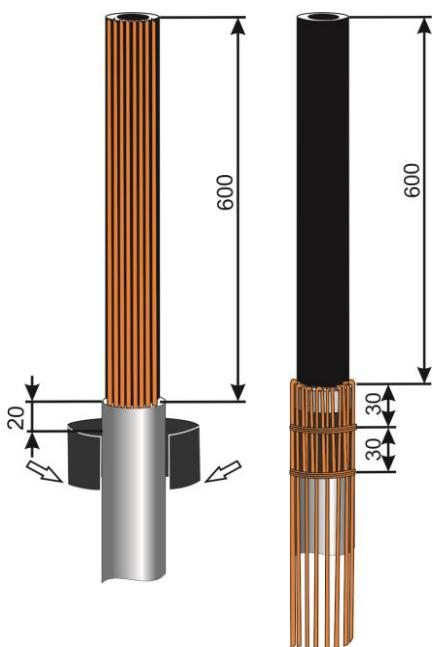
2. На расстоянии 20мм от среза оболочки, как указано на рисунке, наложить герметик. Отогнуть проволоки экрана на оболочку, вдавив их с силой в герметик. Закрепить медные проволоки экрана с помощью двух бандажей, как указано на рисунке.
