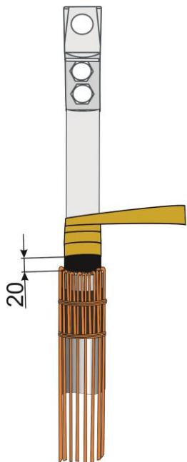
**6. На жилу кабеля надеть трубку стресс-контроль до упора в проволочный экран. Усадку производить от среза электропроводящего экрана в две стороны.**
