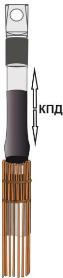
**9.Надвинуть на кабель трекингостойкую трубку, выровняв ее по наконечнику таким образом, чтобы свободной оставалась только контактная часть наконечника. Усадку производить по направлению к наконечнику. Очистить контактную часть наконечника от остатков клея.**
