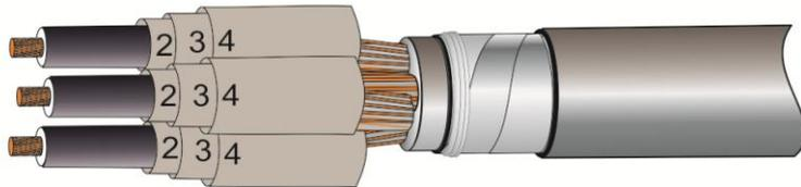
**9.** Ввести зачищенные концы жил в соединитель и затянуть винты до срыва головок.
