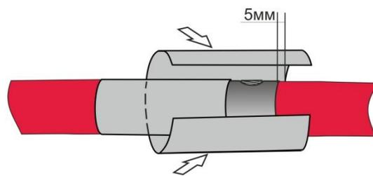
**11.** Надеть на место соединения жил трубку ТТИ №2, разместить по центру и усадить. Усадку производить от центра, не допуская перегрева трубки, образования копоти и сажи. Обезжирить после усадки.
