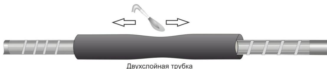
**15.** На усаженную двухслойную трубку произвести намотку экранной сетки с переклестом в 30%.
