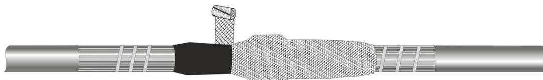
**16.** Закрепить экран сетку у места загиба проволок экрана (на экранирующем слое трубки ТТИЭ №5) бандажом из двух или трёх витков медной проволоки.
