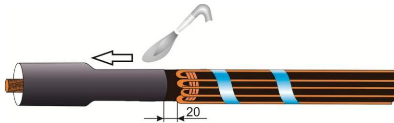
**8. Внимание!** Для предотвращения загрязнения внутренней поверхности защитных кожухов необходимо на оболочку соединяемых кабелей предварительно надеть и зафиксировать плёнку рукавную.
