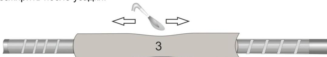
**13.** Надеть на место соединения жил трубку ТТИ №4, разместить по центру и усадить. Усадку производить от центра, не допуская перегрева трубки, образования копоти и сажи. Обезжирить после усадки.
