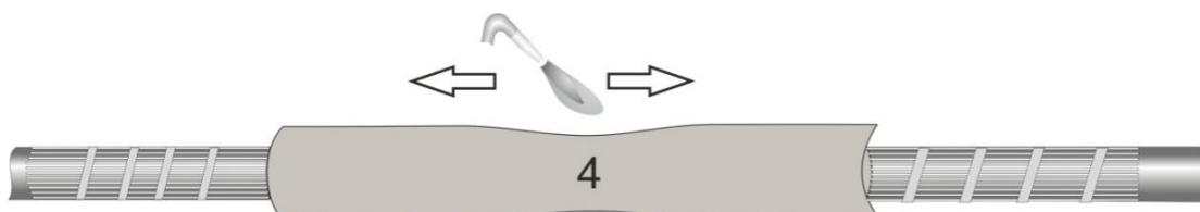
**14.** Надеть на место соединения жил трубку ТТИЭ №5 (двухслойную), разместить по центру и усадить. Усадку производить от центра, не допуская перегрева трубки, образования копоти и сажи. Обезжирить после усадки.
