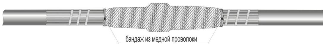
**24.** Снять временно наложенную ленту ПВХ, закрепляющую проволоки экрана большей длины. Отогнуть проволоки экрана так, чтобы они заходили на проволоки экрана меньшей длины. Разложить их параллельно друг другу. Закрепить оба экрана бандажами из медной проволоки в соответствии с рисунком. На место соединения экранов намотать ППД. Выступающие проволоки экрана удалить.
