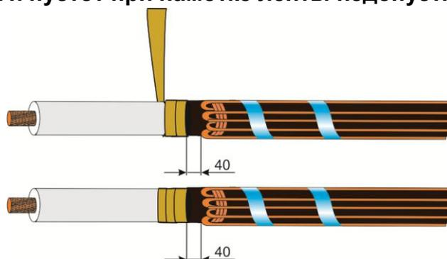
**7.** Надвинуть трубку стресс-контроля №1(ТТР) на жилу кабеля в соответствии с рисунком и усадить. Усадку производить от проволок экрана к торцу жилы. После остывания удалить торцы трубок, выходящие за пределы изоляции.
