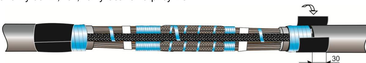
**30.** Надвинуть на муфту одну из трубок защитного кожуха так, чтобы торец трубки выходил на расстояние не менее 150мм за срез оболочки кабеля. Усадить трубку. В предполагаемом месте перехлёста труб нанести герметик. Надвинуть вторую трубку аналогично первой. Перехлест между трубками должен составлять 150-200мм. Усадить вторую трубку внешнего защитного кожуха.
