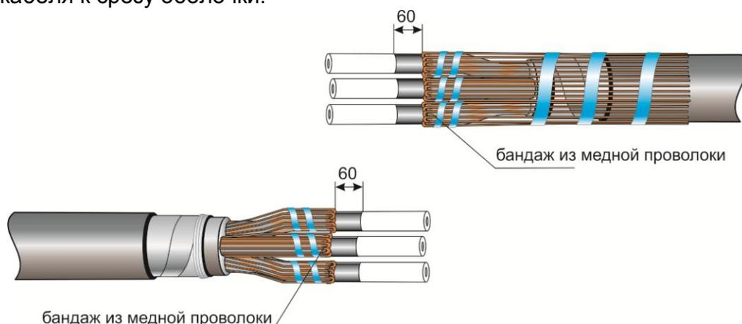
**5.** С конца каждой жилы снять фазную изоляцию на длине, равной половине длины соединительной гильзы.
