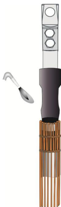
6. На жилу кабеля надеть трубку стресс-контроль до упора в проволочный экран. Усадку производить от среза электропроводящего экрана в две стороны. Для расплавления жёлтой ленты стресс-контроль необходимо тщательно прогревать место намотки беглым пламенем газовой горелки.
