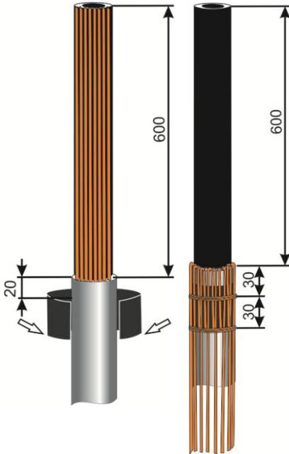
2. На расстоянии 20мм от среза оболочки, как указано на рисунке, наложить герметик. Отогнуть проволоки экрана на оболочку, вдавив их с силой в герметик. Закрепить медные проволоки экрана с помощью двух бандажей, как указано на рисунке.
