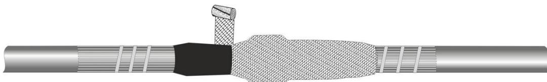
**16.** Закрепить экран сетку у места загиба проволок экрана (на экранирующем слое трубы ТТИЭ №5) бандажом из двух или трёх витков медной проволоки.
