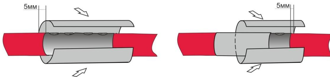
**11.** Надеть на место соединения жил трубку ТТИ №2, разместить по центру и усадить. Усадку производить от центра, не допуская перегрева трубки, образования копоти и сажи. Обезжирить после усадки.
