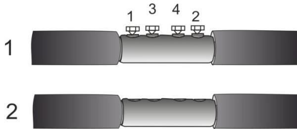
**10.** Обернуть соединительную гильзу пластиной для выравнивания напряжённости электрического поля для гильз, ориентируя пластину в соответствии с рисунком. Пластина должна полностью закрывать гильзу и заходить на жилы кабеля не более чем на 5 мм, переходы пластины должен закрывать место срыва болтов.
