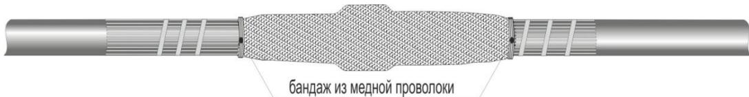
**17.** Снять временно наложенную ленту ПВХ, закрепляющую проволоки экрана. Сплести медные проволоки экрана в косички, обрезать на расстоянии, указанном на рисунке, разложить вдоль кабельной муфты в направлении друг к другу.
