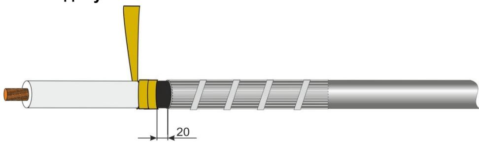
**7.** Надвинуть трубку стресс-контроля №1(ТТР) на жилу кабеля в соответствии с рисунком и усадить. Усадку производить от среза оболочки к торцу жилы. Удалить торцы трубок, выходящие за пределы изоляции.
