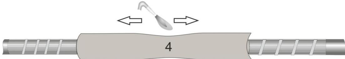
**14.** Надеть на место соединения жил трубку ТТИЭ №5 (двухслойную), разместить по центру и усадить. Усадку производить от центра, не допуская перегрева трубы, образования копоти и сажи. Обезжирить после усадки.
