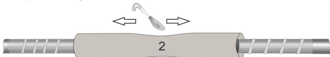
**12.** Надеть на место соединения жил трубку ТТИ №3, разместить по центру и усадить. Усадку производить от центра, не допуская перегрева трубки, образования копоти и сажи. Обезжирить после усадки.
