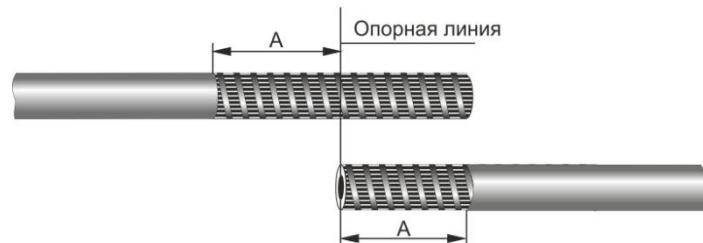
**3.** Обрезать медную бандажирующую ленту проволочного экрана у среза оболочки. Отогнуть проволоки экрана и расположить их на оболочке кабелей параллельно друг другу, временно закрепить лентой ПВХ. Обрезать жилы по опорной линии. Размотать и удалить электропроводящую бумагу до места загиба проволок экрана. Длина жилы кабеля в зависимости от сечения должна соответствовать размерам, приведённым в Таблице №2.
