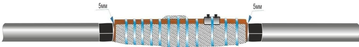
**18.** Надвинуть наружную трубу на собранную муфту, расположить её симметрично относительно центра. Усадить трубу, начиная с середины. Усадку производить в обе стороны.
