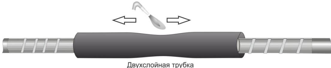
**15.** На усаженную двухслойную трубку произвести намотку экранной сетки с перехлестом в 30%.
