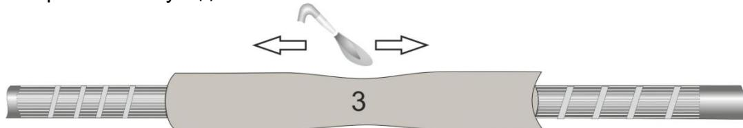
**13.** Надеть на место соединения жил трубку ТТИ №4, разместить по центру и усадить. Усадку производить от центра, не допуская перегрева трубы, образования копоти и сажи. Обезжирить после усадки.
