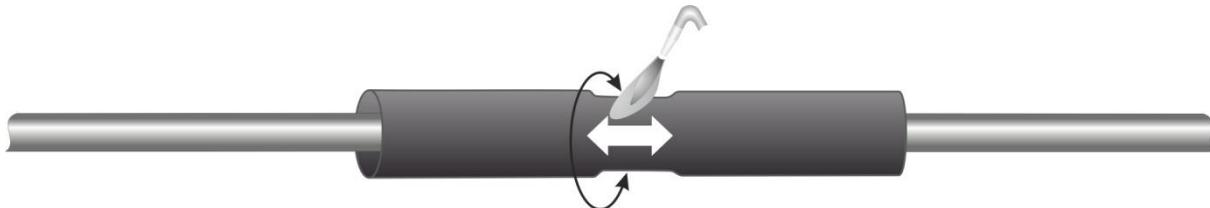
Монтаж муфты окончен. Не подвергать механическим воздействиям до полного остывания.
