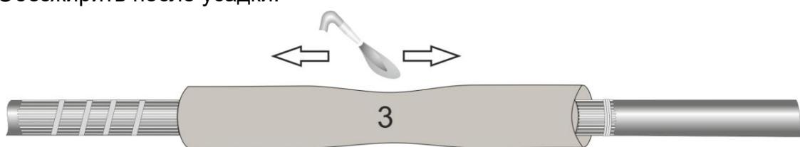
**13.** Надеть на место соединения жил трубку №4, разместить по центру и усадить. Усадку производить от центра, не допуская перегрева трубы, образования копоти и сажи. Обезжирить после усадки.
