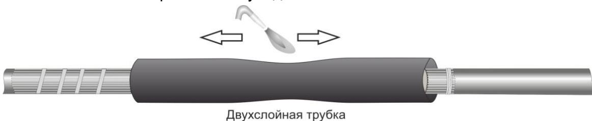
**15.** На усаженную двухслойную трубку надвинуть экран из сетки рукавной, расправить экран по трубке так, чтобы он плотно облегал экранирующий слой трубы.
