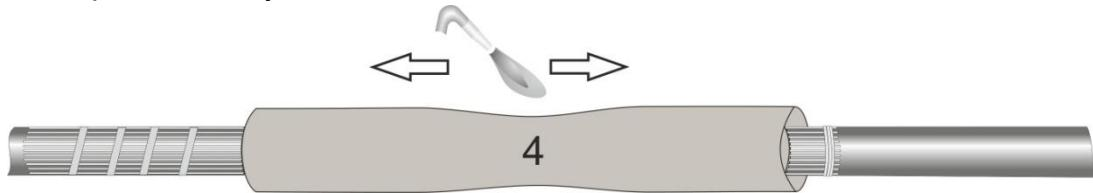
**14.** Надеть на место соединения жил трубку №5 (двуслойную), разместить по центру и усадить. Усадку производить от центра, не допуская перегрева трубы, образования копоти и сажи. Обезжирить после усадки.
