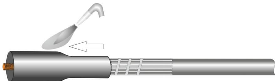
**8.** Надвинуть на кабель, с предварительно надетой плёнкой рукавной, для защиты внутренней поверхности трубок от грязи, термоусаживаемые трубы: изолирующую трубку ТТИ, изолирующую трубку с экранирующим слоем ТТИЭ и трубку-кожух.
