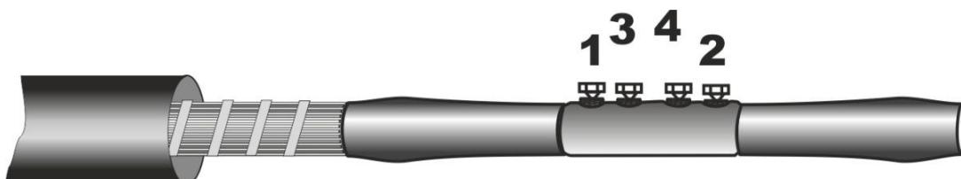
**10.** Обернуть соединительную гильзу (ориентируясь узкой стороной пластины по длине гильзы) самослипающейся пластиной для выравнивания напряжённости электрического поля. Переход пластины должен находиться на место срыва болтов. Краями пластины сравнять переход - изоляция СПЭ-гильзы.
