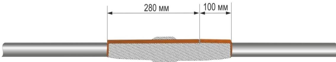
**16.** Произвести соединение экрана кабеля с помощью болтового соединителя в соответствии с рисунком. Зафиксировать медный проволочный экран с помощью ленты ПВХ.
