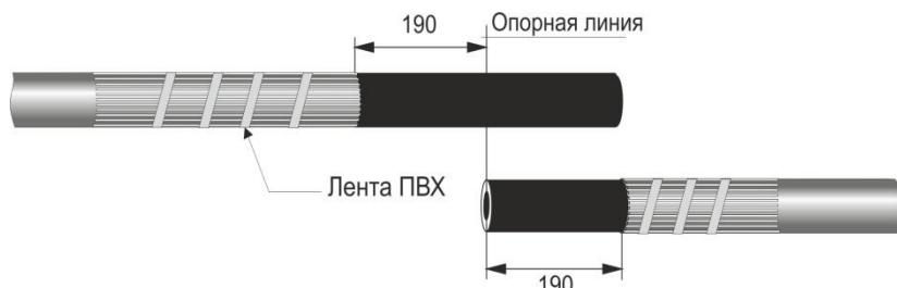
**4.** С помощью специального инструмента (роликового ножа) снять электропроводящий экран с жилы кабеля, оставив участок экрана длиной 40мм у среза оболочки кабеля. Поверхность полиэтиленовой изоляции обезжирить салфеткой с растворителем в направлении от торца кабеля к срезу оболочки.
