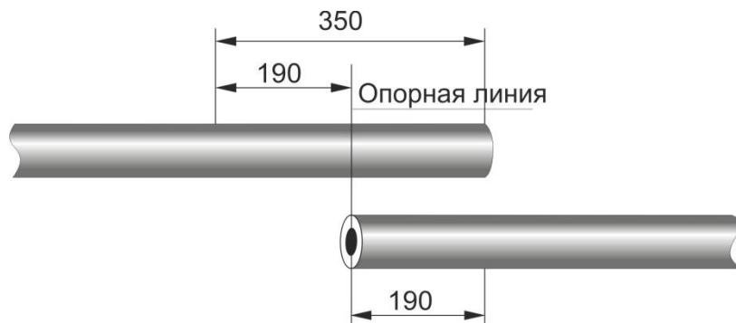
**2.** Очистить наружный покров кабелей на длине 1000мм. Удалить оболочку кабеля по размерам, указанным на рисунке. Для облегчения снятия оболочки подогреть её беглым пламенем газовой горелки.
