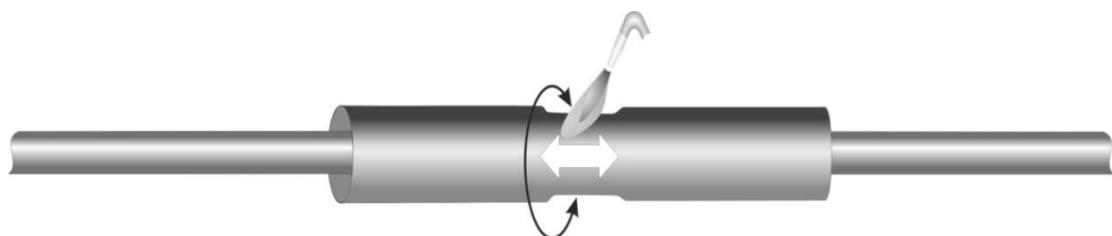
**19.** Монтаж муфты закончен. Не подвергать механическим воздействиям до полного остывания.
