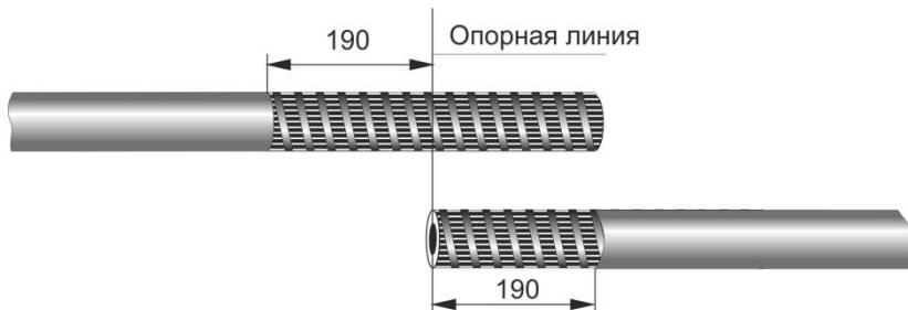
**3.** Удалить ленту, бандажирующую экран. Отогнуть проволоки экрана и расположить их на оболочке кабелей параллельно друг другу, временно закрепить лентой ПВХ. Обрезать жилы по опорной линии. Размотать и удалить электропроводящую бумагу до места загиба проволок экрана.
