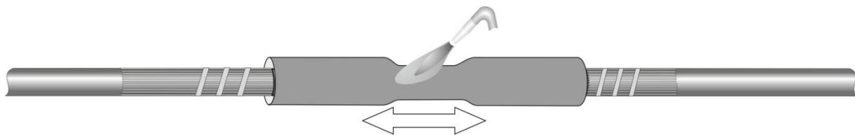
**12.** Надвинуть изолирующую трубку с экранирующим слоем (ТТИ), разместить по центру и усадить. Усадку производить от центра.
