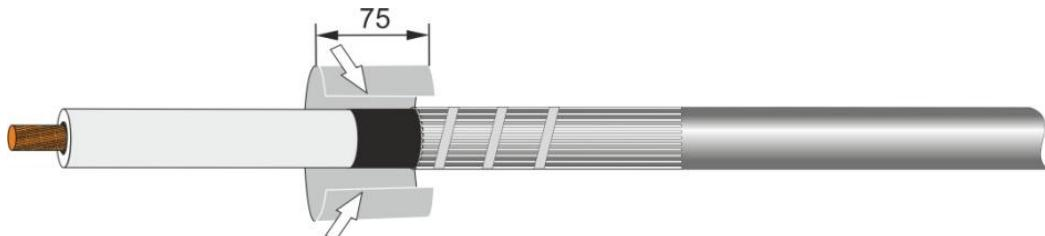
**7.** Надвинуть фазную изолирующую трубку на жилу кабеля до среза оболочки и усадить. Усадку производить от среза оболочки к концу жилы.
