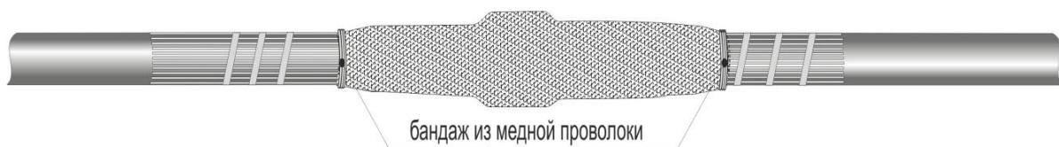
**15.** Снять временно наложенную ленту ПВХ, закрепляющую проволоки экрана. Сплести медные проволоки экрана в косички, обрезать на расстоянии, указанном на рисунке, разложить вдоль кабельной муфты в направлении друг к другу.
