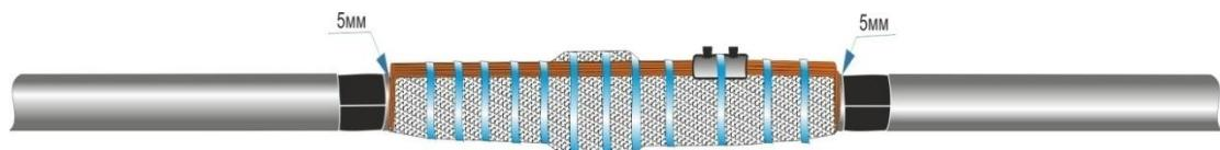
**18.** Надвинуть наружную трубу на собранную муфту, расположить её симметрично относительно центра. Усадить трубу, начиная с середины. Усадку производить в обе стороны.
