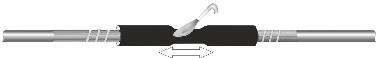
**13.** На усаженную трубку произвести намотку экранной сетки с перехлестом в 30 %.
