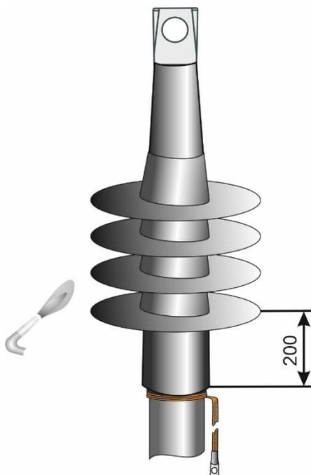
**10.** Усадить поверх трекингостойкой трубки изоляторы в соответствии с рисунком.
