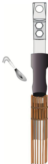
6. На жилу кабеля надеть трубку стресс-контроль до упора в проволочный экран. Усадку производить от среза электропроводящего экрана в две стороны.
