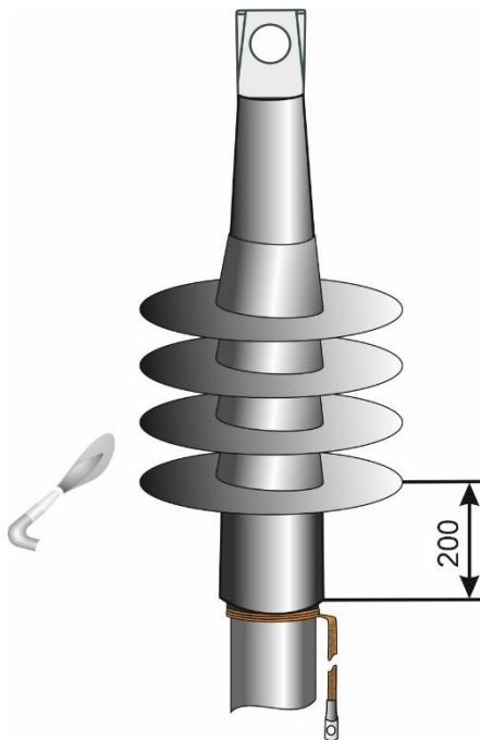
**10.**Усадить поверх трекингостойкой трубы изоляторы в соответствии с рисунком.
