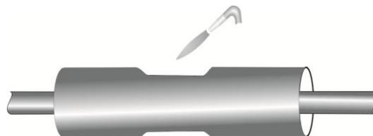
**12.**Монтаж муфты закончен. Не подвергать муфту механическим воздействиям до полного остывания во избежание нарушения герметизации.
