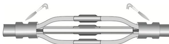
**11.**Надвинуть на муфту термоусаживаемую трубу для герметизации муфты, расположив её симметрично относительно центра муфты. Удалить пленку рукавную. Усадить трубу равномерным пламенем, начиная от середины. После усадки по торцам муфты должен выступить расплавленный клей.
