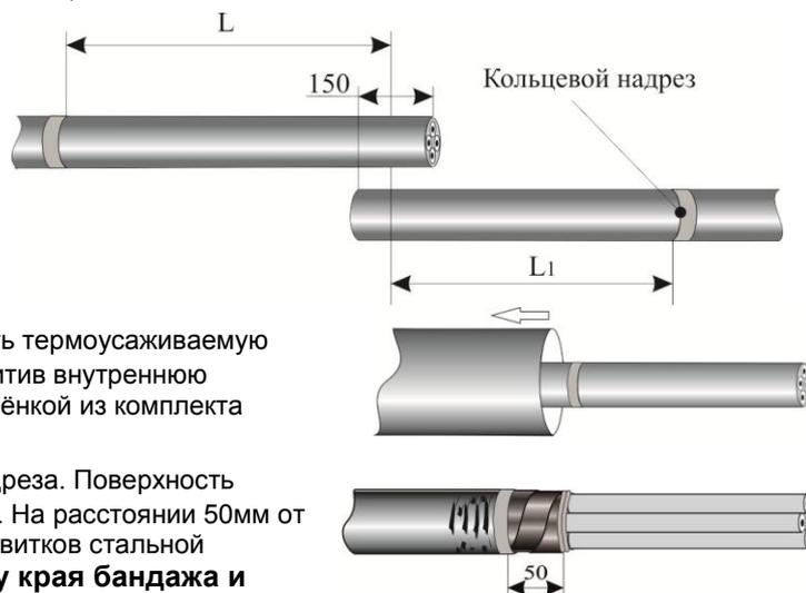
2. На конец одного из соединяемых кабелей надвинуть термоусаживаемую трубу для герметизации муфты, предварительно защитив внутреннюю поверхность трубы от загрязнения полиэтиленовой плёнкой из комплекта муфты.
