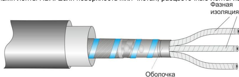
5. Надеть на жилы кабелей термоусаживаемые маслостойкие трубки № 3 для изоляции жил так, чтобы торец трубки доходил до ступени поясной изоляции кабеля, и усадить, начиная от корешка разделки, равномерным прогревом пламени газовой горелки. Пламя горелки должно быть размытым, желтоватого цвета. После усадки трубки должны плотно облепать жилы кабеля, не иметь морщин и складок.
