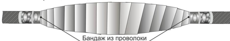
**19. Монтаж провода заземления для комплектации с паяной системой заземления.**
