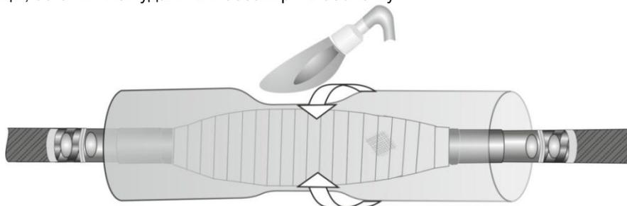
**18.** Обмотать поверхность трубы лентой алюминиевой так, чтобы края ленты заходили на металлическую оболочку кабеля на 10 мм, и закрепить ленту алюминиевую на оболочке кабеля бандажом из 4-5 витков стальной оцинкованной проволоки. Удалить края ленты, выступающие за бандаж.
