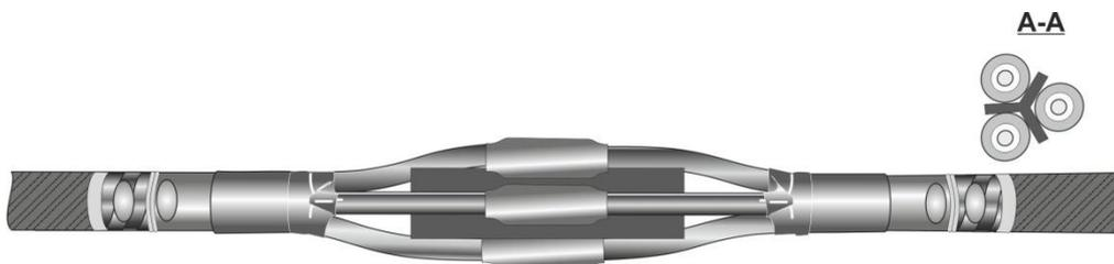
15. **Предварительно прогреть жилы кабеля беглым пламенем газовой горелки,** разложить между жилами межфазный наполнитель так, чтобы плоская, более широкая сторона пластин была обращена наружу. Максимально вдавить наполнитель в пространство между жилами и пальцами перчаток. Руками придать наполнителю цилиндрическую гладкую форму по всей длине муфты. При низкой температуре до укладки подогреть внутреннюю поверхность наполнителя, а после укладки - внешнюю поверхность по всей площади пластин.
