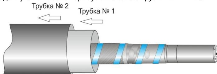
4. Снять оболочку кабеля от конца кабеля до второго кольцевого надреза. Удалить электропроводящую бумагу, поясную изоляцию и кордели. Жилы кабеля аккуратно развести, не загрязняя поверхность. Закрепить изоляцию на концах жил 1-2 витками ленты ПВХ. Если поверхность жил чистая, расцветочные ленты изоляции не снимать.
