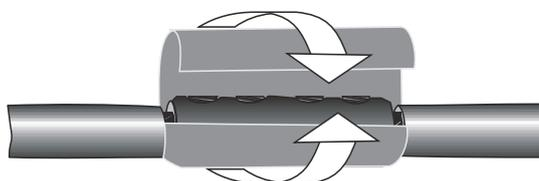
13. Надвинуть на гильзы строго симметрично термоусаживаемые манжеты № 4 для изоляции контактного соединения (полупрозрачные). Усадить манжеты, начиная от середины, мягким пламенем, не допуская пережога. Для равномерной теплопередачи периодически отводить горелку. Во избежание преждевременного приклеивания поддержать манжету. После усадки на торцах манжет должен выступить клей.
