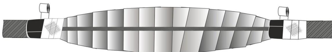
**22.**Надвинуть на муфту наружную термоусаживаемую трубу № 2 - наружный защитный кожух, расположив ее симметрично относительно центра муфты. Удалить пленку рукавную. Усадить трубу пламенем газовой горелки, начиная от середины. После усадки по торцам трубы должен быть заметен выступивший расплавленный клей.
