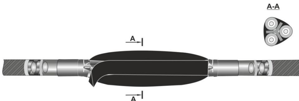
16. Максимально сжать жилы и по поверхности наполнителя выполнить стягивающую подмотку стеклоленты для бандажирования наполнителя с натяжением без нахлестов.
